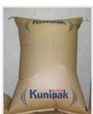
エアーダンネージはコンテナなど積荷の隙間に挿入し、後から空気を注入して積荷を安定させる緩衝材です。輸送中の振動・衝撃を吸収し貨物の移動、荷崩れ、荷傷みを防止する極めて強靭で軽量なエアバッグです。
